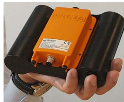
Eine Kamera des Systems mRC-3D mit der AIMS-Kassette, die vollautomatisch eine saubere Schutzfolie vor den Doppelsensor transportiert
