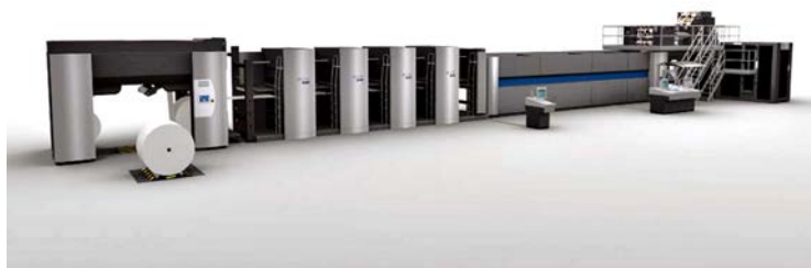
Goss M800 zur Installation bei Beijing Daily mit vier Druckeinheiten
