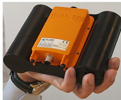
Cámara mRC-3D con cassette AIMS, que desliza de forma totalmente automática una película protectora limpia delante de los sensores dobles.
