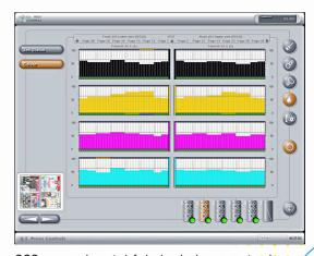
GOScreen: en la parte inferior izquierda se muestran las páginas a todo color para las que se muestra el suministro de mojado. En el centro, figura la posición de las trampillas de agua en la dosificación de spray de mojado. La línea central horizontal se refiere a los valores predeterminados del mojado. La unidad a color de la parte inferior derecha indica el centro de atención.
