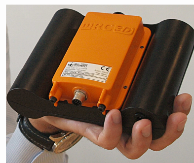
Câmera m RC-3D com gaveta de proteção AIMS, que coloca automaticamente um filme protetor diante dos sensores duplos
