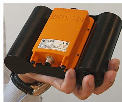
装有自动墨雾防护装置的 mRC-3D 相机,
