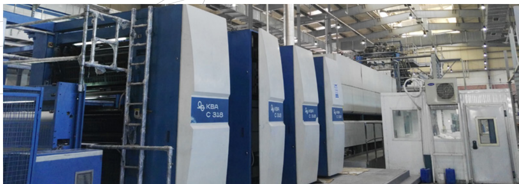
安装了QIPC系统的KBA Compacta 318印刷机。
