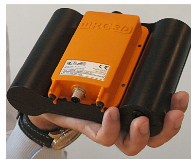
Caméra mRC-3D équipée d'une cassette AIMS déroulant automatiquement un film de protection propre devant l'optique du double capteur.
