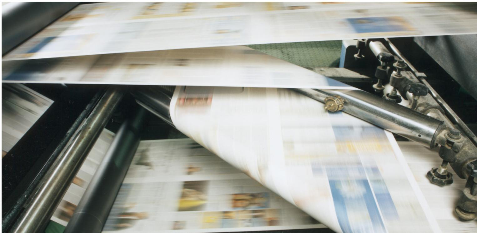
*La produzione di Mediaprint è suddivisa su tre centri stampa in cui sono installate un totale di 13 rotative KBA Commander che saranno modernizzate nel quadro di un vasto progetto di retrofit.*
