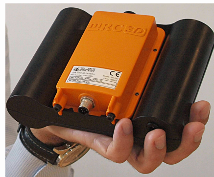
m RC-3D camera met AIMS-cassette, die volautomatisch een schone beschermfilm voor de dubbel sensoren schuift.
