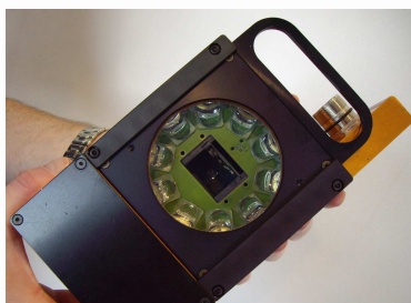
mRC camera; energiereduceerd door led-verlichting.
