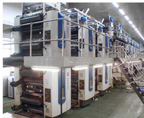
Goss Magnum, enkele breedte krantenpers; typisch voor de Chinese regio
